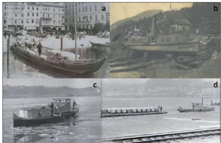
Abb. 12: In den Anfängen wurde der gebrannte Kalk mit Zillen zum Verkauf auf den Rathausplatz von Gmunden transportiert (a). Ab 1924 wurde der Personendampfer Hubert Salvator vom Attersee als Zugschiff „Kalkwerk I“ für die Kalkfahren eingesetzt (b), der 1937 umgebaut, motorisiert und damit leistungsstärker wurde (c). Zuletzt wurde ein Zugschiff aus Linz organisiert, „Kalkwerk II“, das die lokale Bevölkerung nach seinem Führer Hans Hauer „Hauerschiff“ nannte (d).
